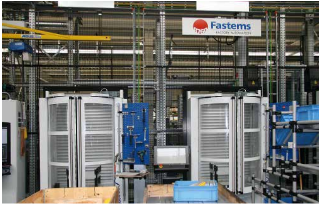
Die vier Matsuura H.Plus 405 sind mit einem Fastems Palettenspeicher mit einer Kapazität von 90 Paletten und drei Lade-/Rüststationen miteinander verbunden.
