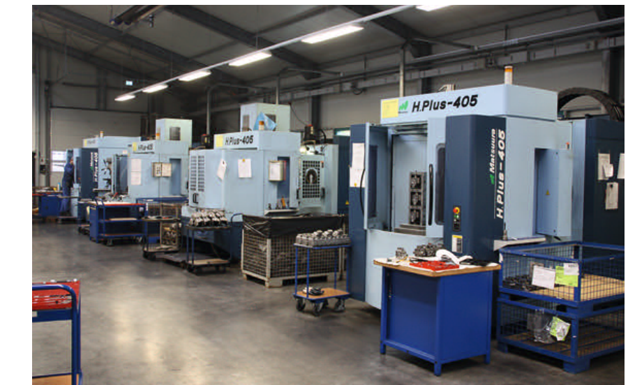
4 Vier 4-Achs-Horizontal-BAZ H.Plus-405 in Reihe: Die neueren Modelle beanspruchen bei gleich großen oder gar größeren Arbeitsräumen eine geringere Stellfläche als ihre Vorgänger – darauf legt Matsuura bei der Entwicklung besonders Wert
