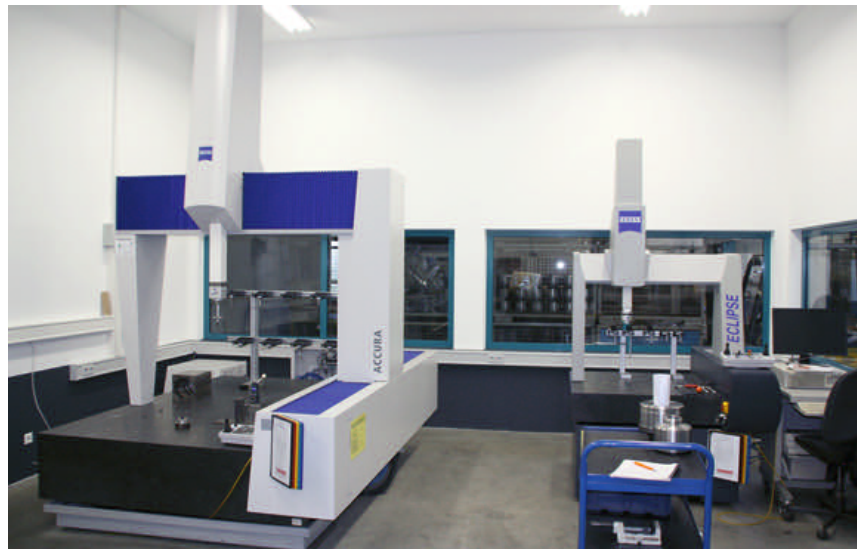
5 Messtechnik vom Feinsten: Koordinatenmessgeräte zur Form- und Konturprüfung von Zeiss, Mahr und Hommel beherrschen den Messraum, in dem zusätzlich zur Werker selbstkontrolle Stichproben – nach definierten Prüfintervalen – vorgenommen werden
