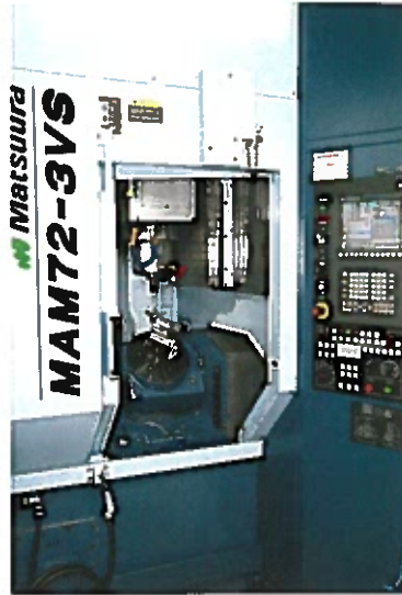
Allein die Gusskonstruktion wiegt mehr als 6 Tonnen.
