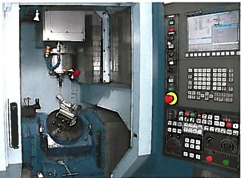
Features wie beispielsweise eine direkte Wegmessung für B- und C-Achse und den Linearachsen X/Y/Z gehören bei der MAM72-3VS zur Standardausstattung.
