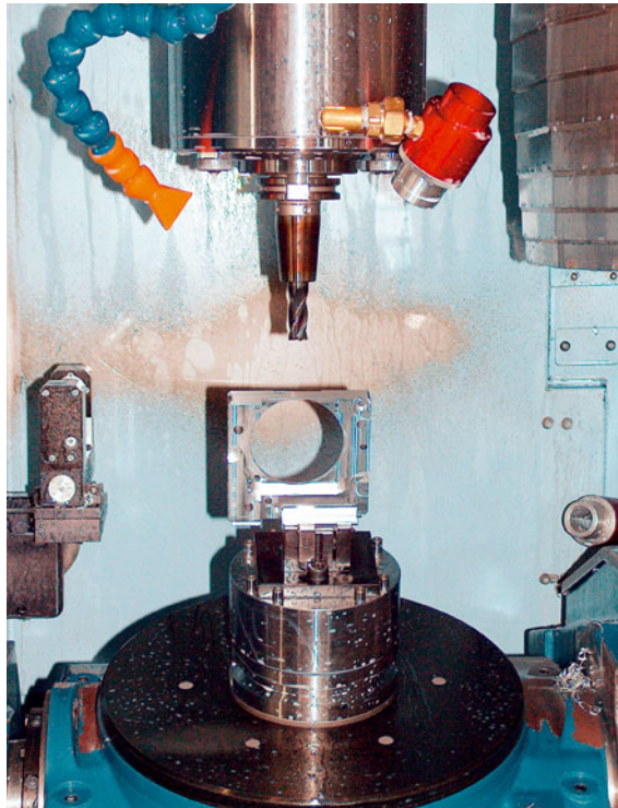
4 An fünf Seiten ohne Umspannen: Auf Paletten geschickt gespannte Werkstücke werden auch in mannlosen Schichten komplett bearbeitet
