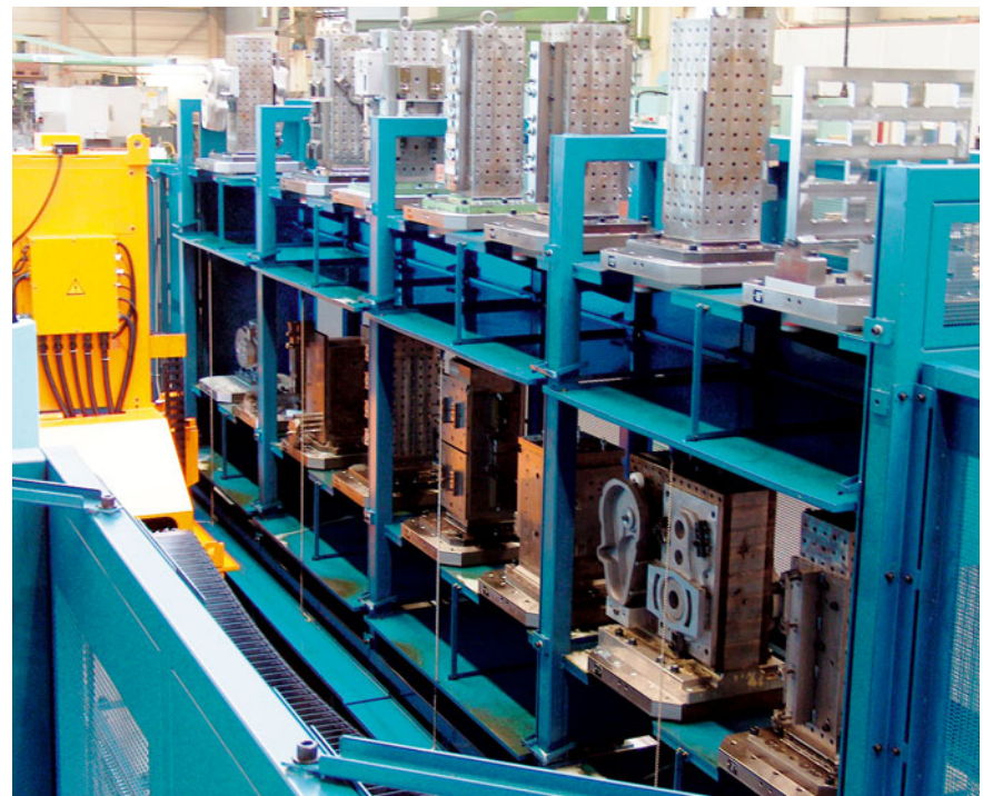
5 Großer Vorrat minimiert Rüstzeiten: Durch 17 Plätze im Palettenbahnhof können die Spannblöcke und -vorrichtungen für wiederholt zu fertigende Werkstücke auf Dauer im System bleiben
