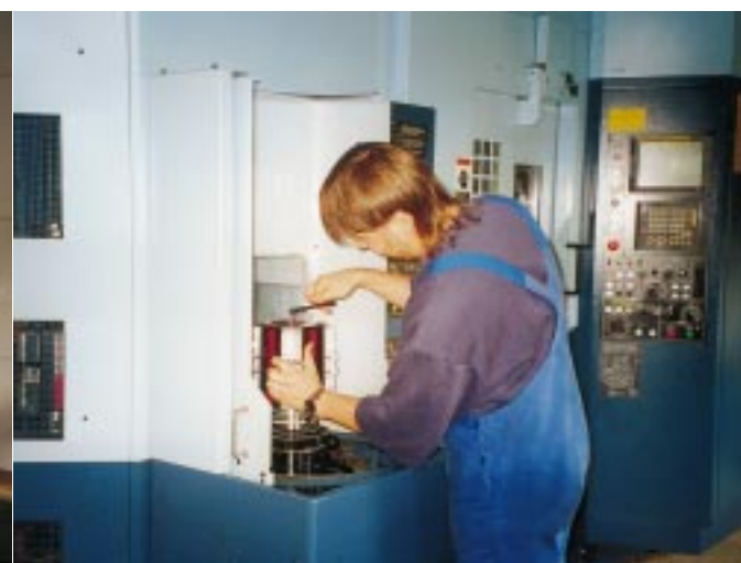
7 Unproblematisch: Wenn Bediener Stefan Weltsch die Werkstückpaletten umrüstet, so geschieht das hauptzeitparallel innerhalb weniger Minuten
