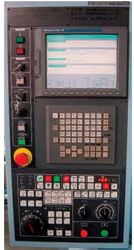
Die Fanuc G-Tech 16i bietet vor allem Vorteile bei der schnellen Programmoptimierung und -erstellung.
