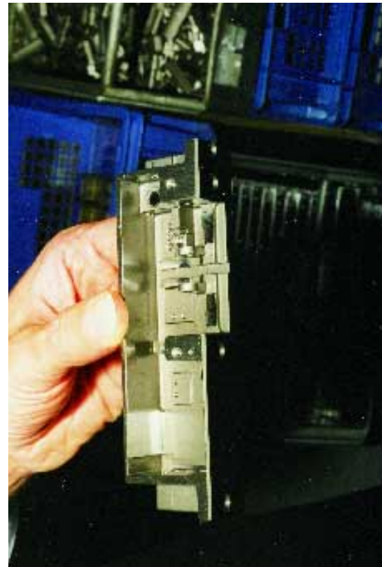
Bei der Fertigung von Teilen für die Sicherheitstüröffner, im Bild ein Gehäuse, werden bei effeff schon seit Jahren 5-Achsenbearbeitungszentren eingesetzt
