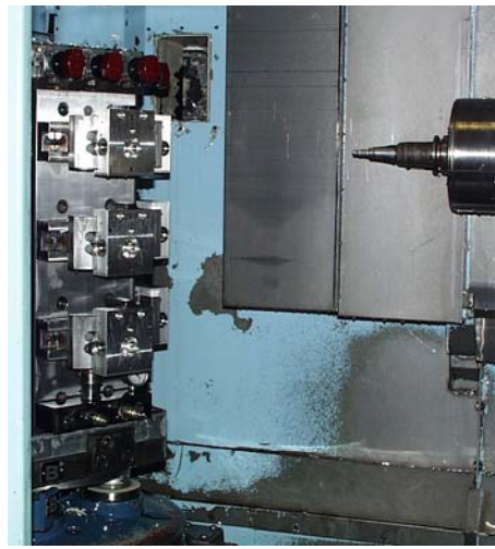
Bild 5: Zwölf Teile auf einer Palette: da bleiben die Werkzeuge lange eingespannt. Das wiederum tut den Hauptzeiten gut.
