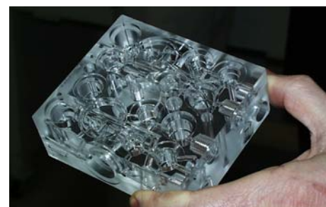
Bild 2: Ein Plexiglasmodell verdeutlicht die Komplexität der Steuerelemente, auch wenn überwiegend „nur“ gebohrt wird
