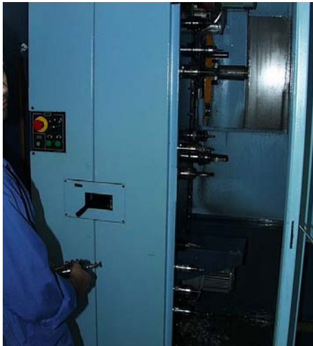
Bild 4: Die bis zu 31 Werkzeuge im Magazin können problemlos während der Hauptzeit gewechselt werden
