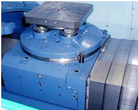
Bild 6: Der Matsuura-Rundtisch hat als vierte Achse 1° als kleinstes Indexierinkrement aufzuweisen
