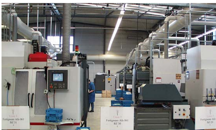
Bild 3: Der Blick in eine Reihe der Maschinen zeigt am Ende eine der zuerst beschafften Matsuuras. Auffällig ist die Menschenleere der Halle, da Mehrmaschinenbedienung angesagt ist
