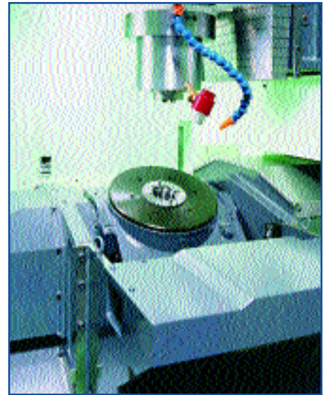
+65° bis -110° in der vierten und 360° in der fünften Achse erlauben die Bearbeitung auch vertrackter Geometrien. Für sehr schlanke Teile kann ein Reitstock zugerüstet werden
