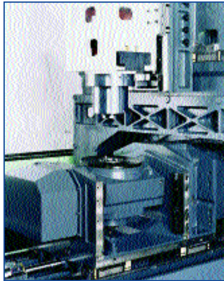
Beidseitig gelagerter Dreh-Schwenktisch mit direkter Wegmessung: Die B- und C-Achsen positionieren auf \pm 2 s wiederholgenau, ihr Drehmoment liegt bei 760 und 270 Nm
