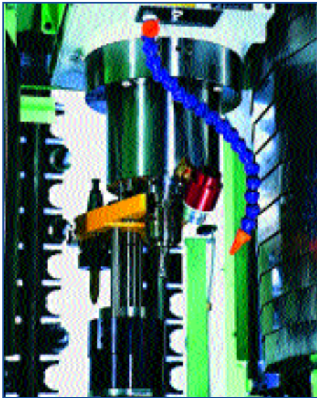
Der Doppelgreifer-Wechsler ist ebenso simpel aufgebaut wie griffsicher. Er tauscht die bis zu 240 Präzisionstools binnen 0,5 s aus dem Magazin. Die Span-zu-Span-Zeit beträgt 5 s
