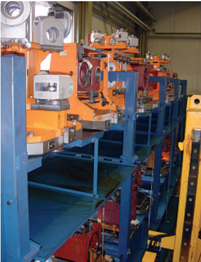
Im integrierten Palettenspeicher können bis zu 17 Paletten zwischengelagert und bei Bedarf ausgeschleust werden.
