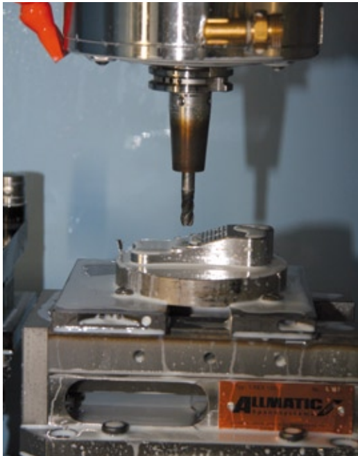
Ein Werkzeugwechsel dauert bei der MAM 72-3VS gerade einmal 0,5 Sekunden
