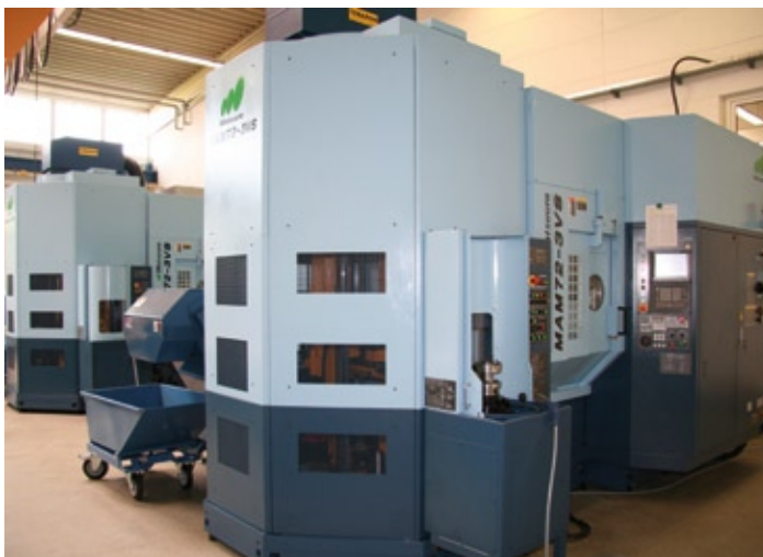
Die MAM72-3VS erreicht eine Positioniergenauigkeit auf dem gesamten Verfahrweg von 0,005 mm bei einer Wiederholgenauigkeit von 0,001 mm.
